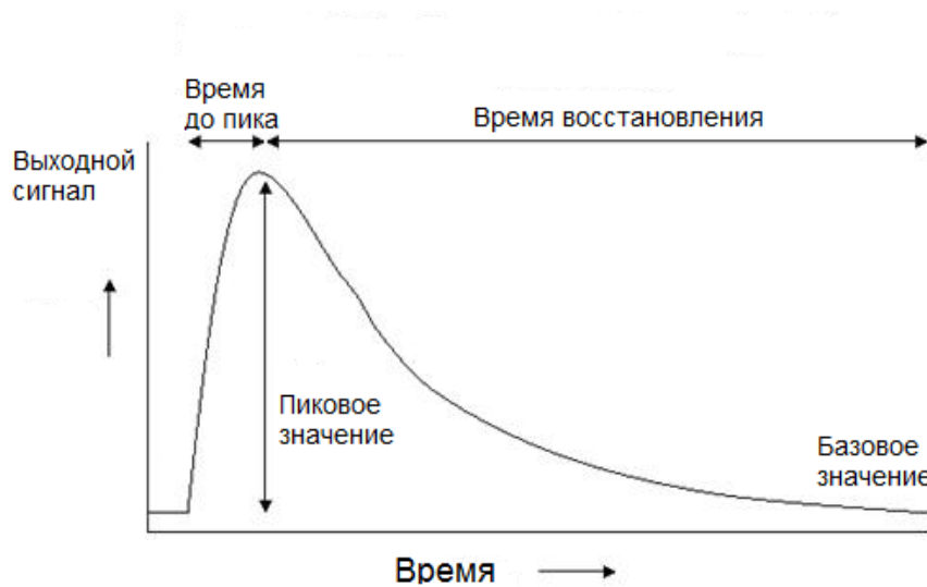
Рисунок 3. Форма изменения сигнала электрохимического датчика
